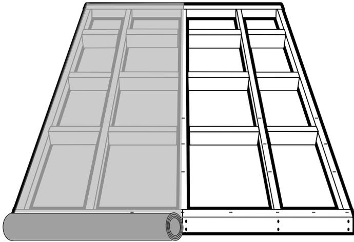
1、完成した根太の上に図の様に防湿シートを貼り、タッカーで仮止めして下さい。
